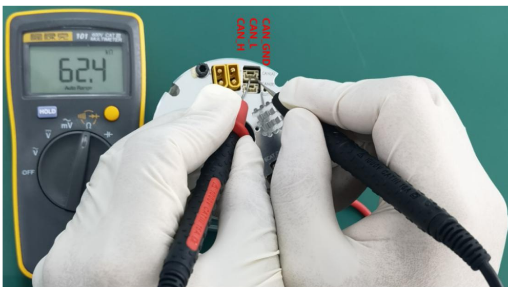
图 26-1 CAN 通信正常电阻测量值
